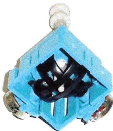
Figura 18 - Mecanismo de um joystick esférico
